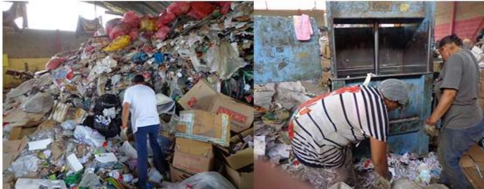
Figura 4: Material segregado para ser reciclado e preparação dos fardos de papel e papelão (Programa Cataforte III).
