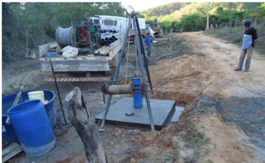
Figura 3: Foto da etapa de realização de Teste de Vazão no poço construído na comunidade de Lapinha, Município de Matias Cardoso/ MG.
