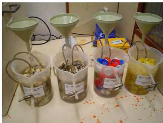
**Figura 7** - Foto do experimento de bancada completo com os 4 reatores (biofiltros).
