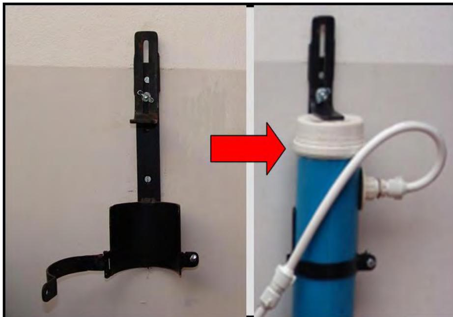
**Figura 15** - Braçadeira de fixação do filtro de desfluoretação.
