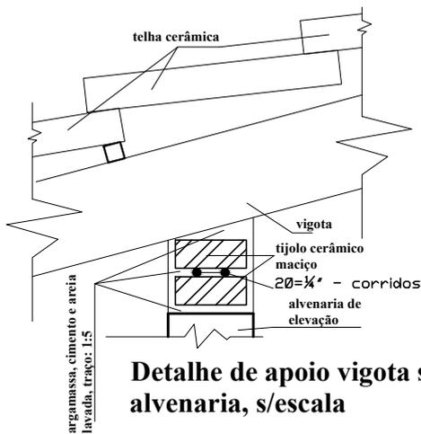
Detalhe de apoio vigota sobre alvenaria, s/escala
